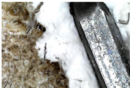
Verso de uma pintura de acrílico sobre tela, com destaque para uma área que representa, respectivamente, verniz, somente tecido e grampo metálico, utilizando um microscópio portátil, com zoom de 1600x.
