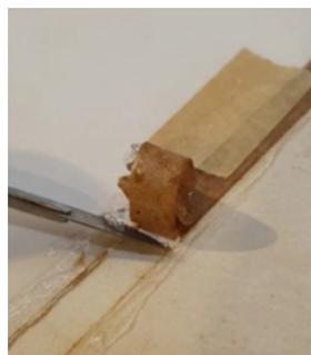
Remoção de fita gomada após aplicação de gel à base de água. Imagem cedida por Lívia Lira e Liège Zampol.
